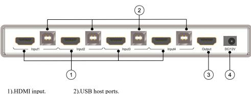
1).HDMI input.2).USB host ports.3).HDMI output.4).12V DC power input.
